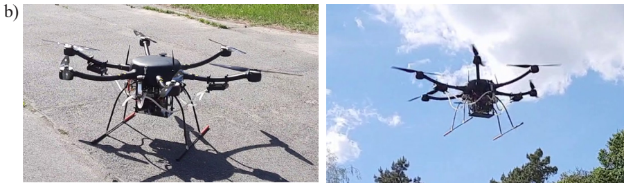
Rys. 6. Sylwetki opracowanej platformy BSP systemu MilGeoMed w wersji: a) z napędem elektrycznym; b) z napędem hybrydowym (elektryczny/benzyna)
