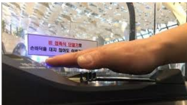
Rysunek 2. Identyfikacja pasażera w systemie uwierzytelniania żył dłoni
